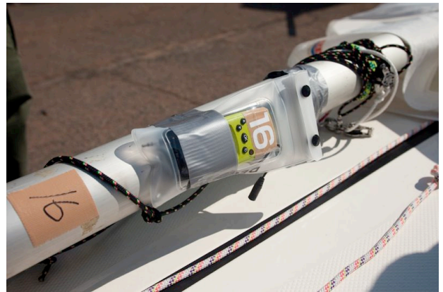
シーホッパー級 SR のマストに取り付けられた ハンディ GPS 端末
